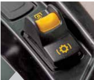
Voimanoton kytkentä on sähköhydraulinen 3-asentoisella turvakytkimellä (On, Off ja lukitus/jarru).
