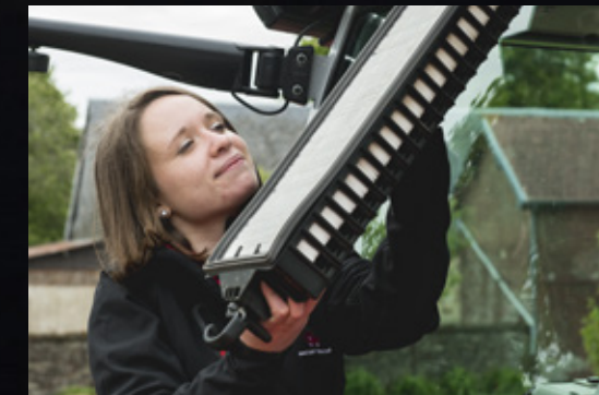
Ohjaamon ilmansuodatin on helposti irrotettavissa puhdistusta varten.
