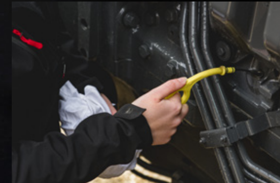
Etuakseli ja kapea konepelti helpottavat öljyn määrän tarkistamista ja suodattimen vaihtamista.
