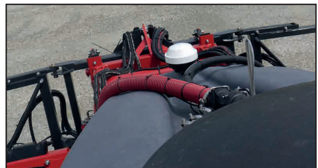
GPS-vastaanotin asennettuna seossäiliöön
