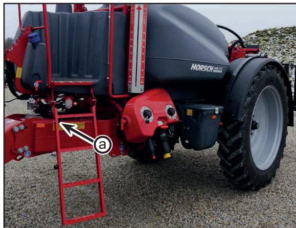
Käännettävät tikkaat - jousikuormitettu lukituspultti (a)
