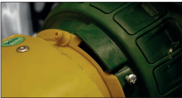
Ulkosuojaputken asento - ei paikoilleen lukittuneena
