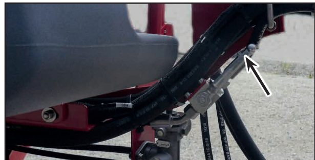
Sulkuventtiilin asento pellolla ajettaessa
