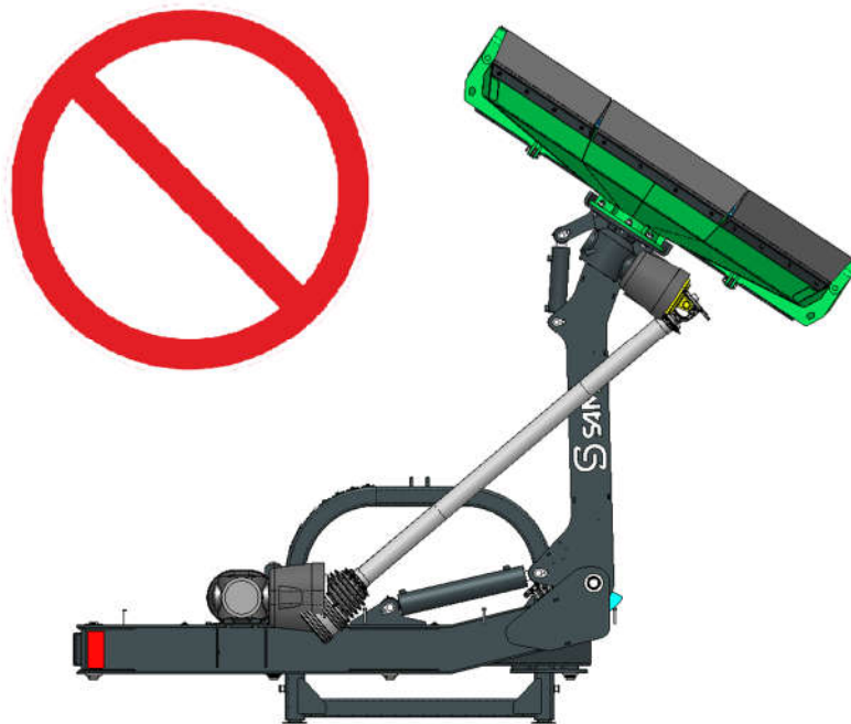
Kuva 6. Ketjumurskaimen kielletty asento.
