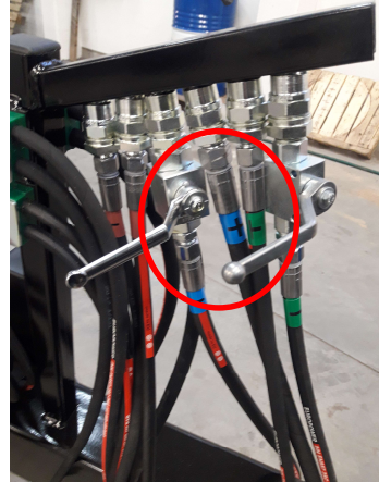
Kuva 2. Työsyvyyden sulkuvipu. Venttiili auki letkujen suuntaisesti. Kuvassa venttiili kiinni. Letku merkitty sinisellä.
