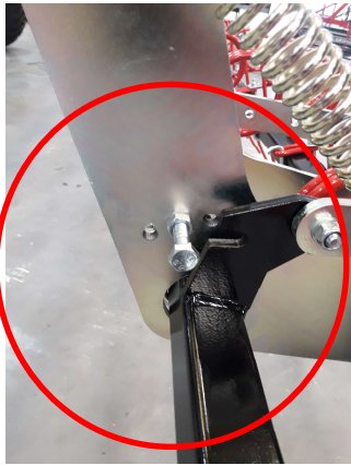
Kuva 13. Jälkiharojen säätö 1 ja 2 -rivinen.
