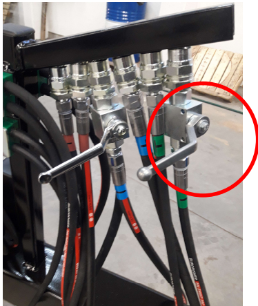
Kuva 1. Sivulohkojen sulkuvipu. Venttiili auki letkujen suuntaisesti. Venttiili kiinni letkusta poispäin. Letku merkitty vihreällä.
