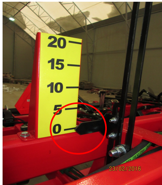
Kuva 10. Työsyvyysmittari sijaitsee äkeen keskilohkon päällä.
