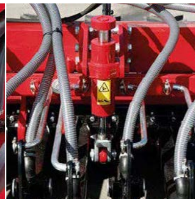
Hydraulisesti säädettävä portaaton vannaspaineen säätö
