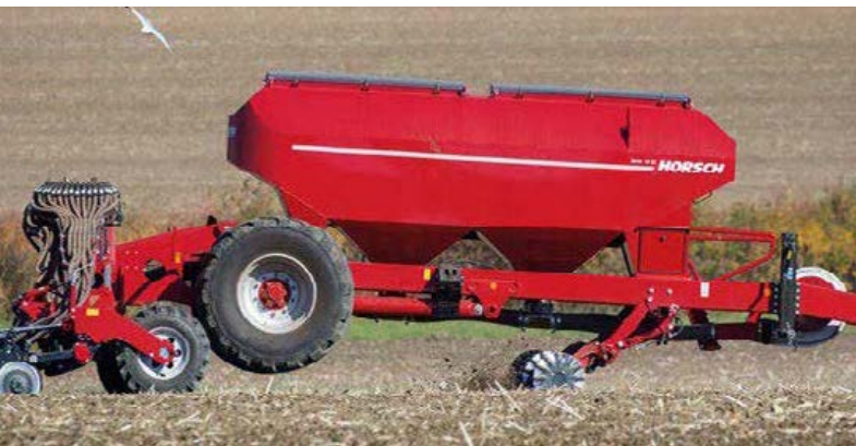
Kaksiosainen paineistettu säiliö suhteessa 60:40 (etuosa 3 600 l, takaosa 2 400 l)
