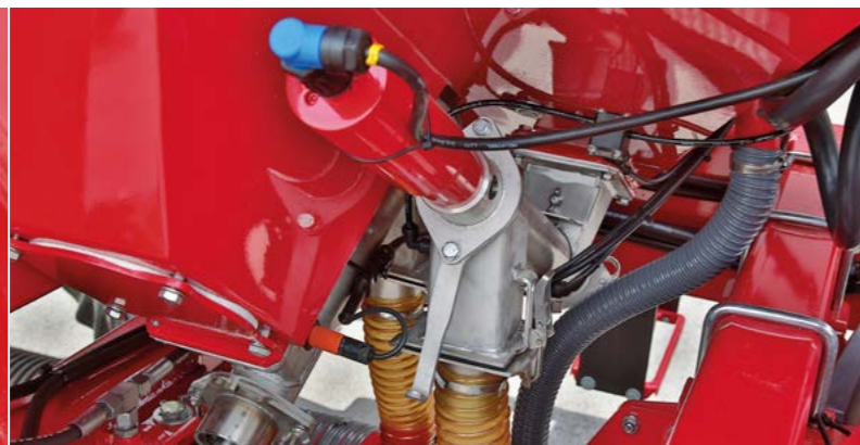
Piensiementen annostelu kierukkasyöttölaitteen avulla
