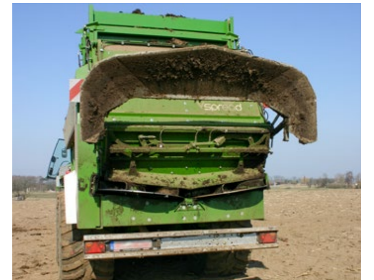
V-Spread-levitysyksikkö, jossa on halkaisijaltaan 100 mm levitinlautaset ja kuusi levitinsipeä.
