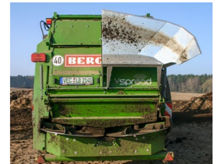
V-Spread-levitysyksikkö, jossa on halkaisijaltaan 1 000 mm levitinlautaset ja neljä levitinsiipä.
