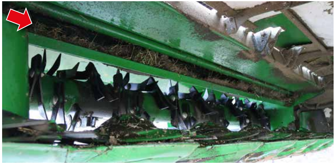
↑ V:n muotoiset murskainsormet ovat terästä. Murskaimen vastateränä toimiva pelti (nuoli) kerää heinää sisäänsä. Kun pelti oli ylimmissä asennossa, kerääntyi sitä vain noin viisi kourallista, mutta ala-asennossa heinälle on tilaa parin sangollisen edestä. Suojapeitteitä ei saa käännettyä ylös, joka hieman hankaloittaa pesua ja terien vaihtoa, vaikka koneen nostaminen auttaakin asiaa huomattavasti.
