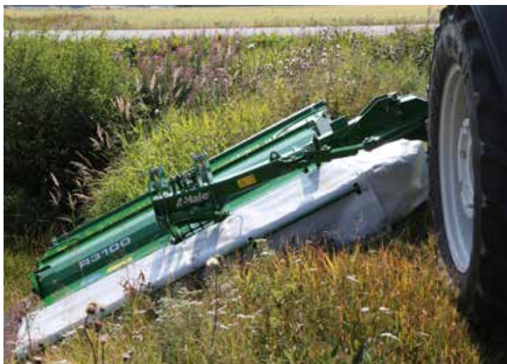
↑ Tarvittaessa McHale sopii myös pientareiden niittoon, sillä vaakapuomi pääsee kallistumaan noin 20 astetta vaakatasosta alaspäin.
