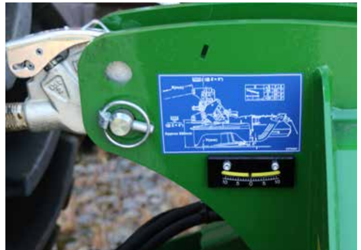
↑ Teräpalkin kulma, eli sängenväli säädetään työntövarren pituutta muuttamalla. Työntövarrenkiinnikkeen kyljessä on vatupassi, jonka avulla halutun kulman saa selville, kunhan traktori on vaakatasossa.
