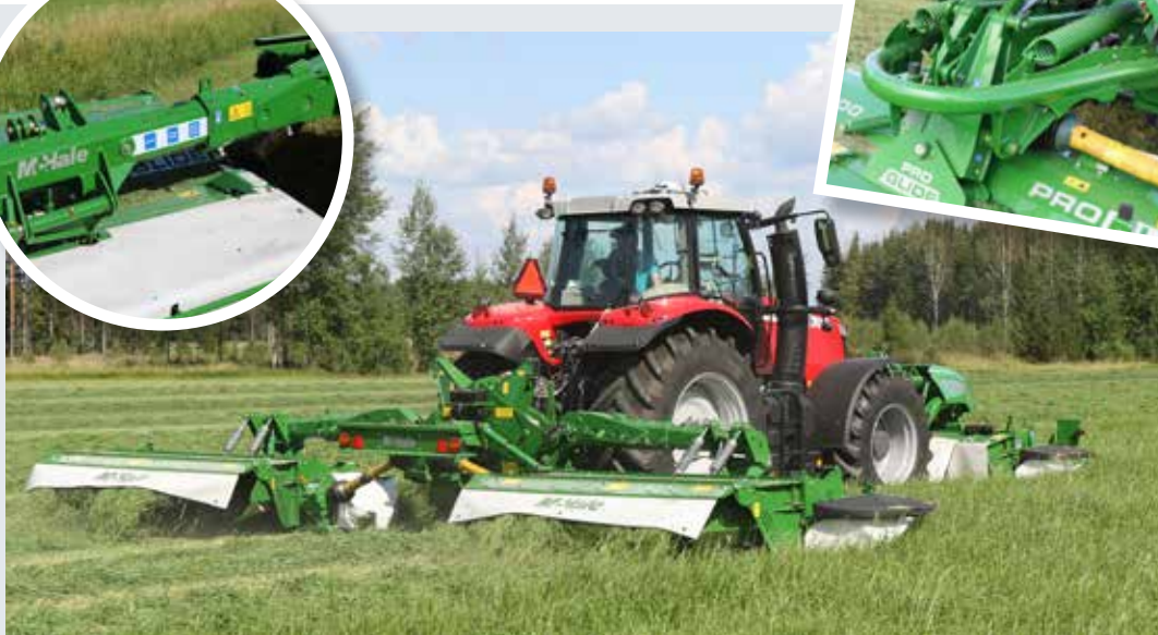
Merkittävin ero yksittäisen takakoneen ja perhosen välillä on teleskooppinen vaakapuomi (pallokuva), jolla voidaan säätää etu- ja takakoneen limitystä. Etuniittokoneen niittoyksikkö on sama kuin takakoneessa, mutta ripustus (neliokuva) on täysin erilainen. Suojuksen alta paljastuu työntävä ripustus.
