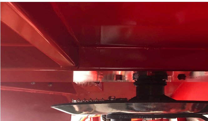
Vapaa korkeus terän ja kannen välillä on tärkeä tekijä suorituskyvyssä. Ag- gressiivinen kannen alapuolinen rakenne parantaa suoritus- ja läpäisykykyä.
