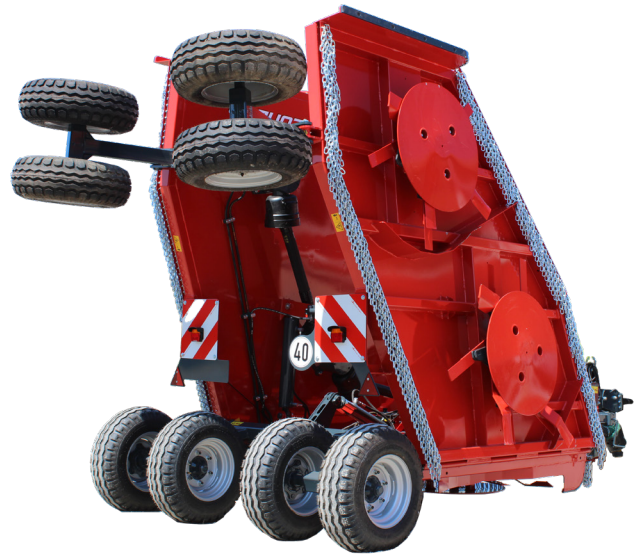
CONDOR 7300 kuljetusasennossa, varustettuna 8:lla renkaalla (vakiona) ja 6:lla terällä.
