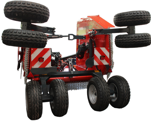
CONDOR 5000 kuljetusasennossa, varustettuna 8:lla renkaalla ja 6:lla terällä.
