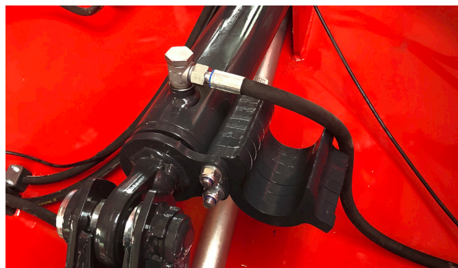
Työkorkeus säädetään sylinterikohtaisesti rajoitinlevyillä.
