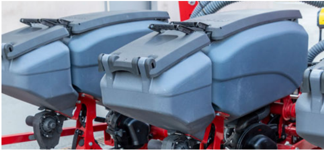
Mikrogranulaattirivisäiliö, tilavuus 20 l.
