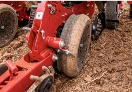
RID-pyörä vähentää maaperän tiivistymistä suoraan kylvöurassa erittäin kovissa tai muokkaamattomissa olosuhteissa.
