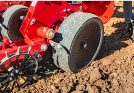
Vakiosyvyysäätpyörä normaalille maaperälle.
