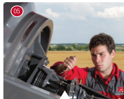
Vauhtipyörän luistokytkimen säätö.
