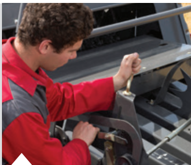
Yksinkertainen ja luotettava paalin pituuden säätö. Paalainkammion keskelle asennettu paalinpituinen tähtipyörä kelluu kammion yläluukun kanssa, minkä ansiosta tähtipyörä saa pitävän vedon kaikissa sato-olosuhteissa, mikä parantaa paalin pituuden tarkkuutta.
