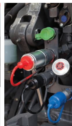
Kaikissa takaliittimissä on hydrauliikan paineenvapautusjärjestelmä.
