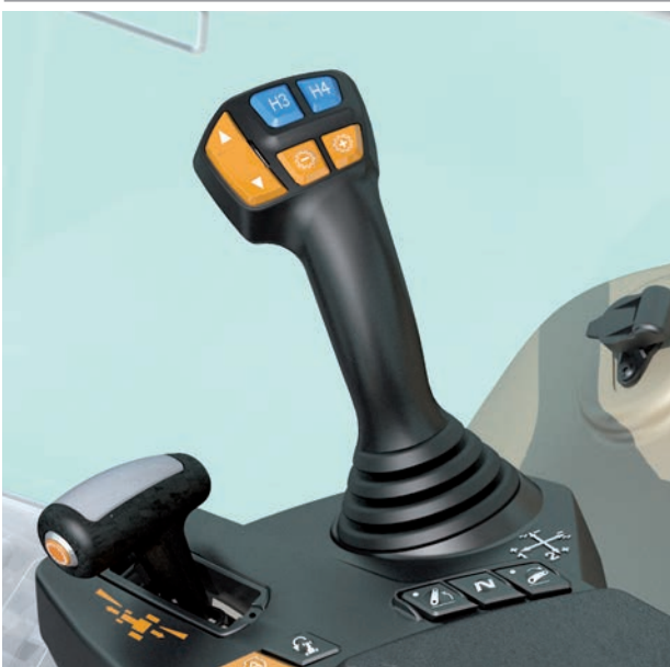
Efficient-ohjaamo, jossa sähköinen monitoimijoystick ja käsinoja
