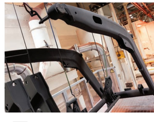
Modernit maalausprosessit varmistavat kuormaimen maalipinnan pitkäikäisyyden ja kestävyuden
