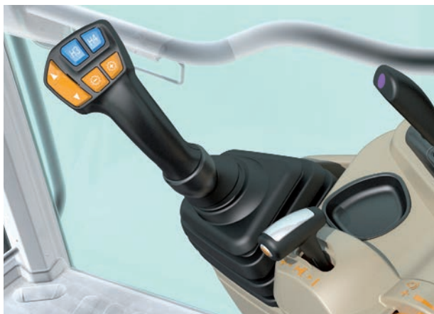
Efficient-ohjaamo, jossa sähköinen monitoimijoystick ja käsinoja
