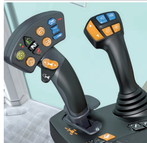
Exclusive-ohjaamo, jossa multipad-ohjausvipu ja sähköinen (oikean käden) monitoimijoystick
