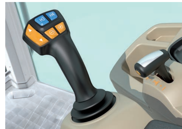
MF 5700 S ja Essential-ohjaamo, jossa sähköinen kuormaimen monitoimijoystick
