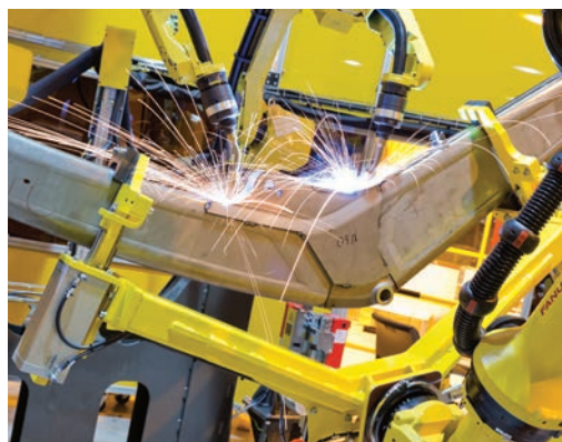
Robotisoitu hitsaus takaa tarkkuuden ja kestävyuden
