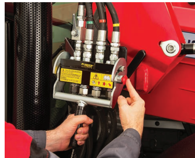
Irrota hydraulili- ja sähköliitännät
