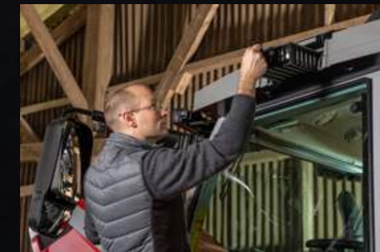
Ohjaamon ilmansuodatin on helposti irrotettavissa puhdistusta varten.
