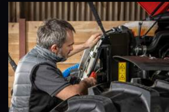
Jäähdytyspaketti on helposti käytettävissä, mikä helpottaa ja nopeuttaa sen puhdistamista.
