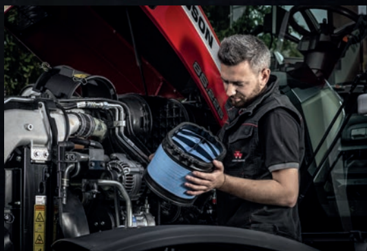
Moottorin ilmansuodattimen vaihtaminen on erittäin helppoa.
