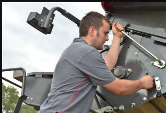
Yksinkertainen vaihto silppuamisesta karholle ajoon paalausta varten
