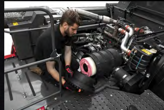
Ilmanpuhdistajan tarkastus ja puhdistus
