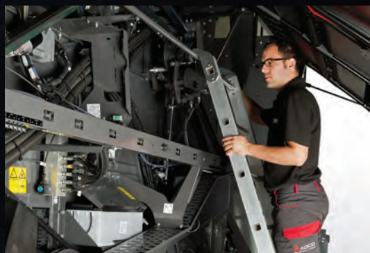
Irrotettavat rappuset tekevät tarkastuksesta helppoa ja turvallista.
