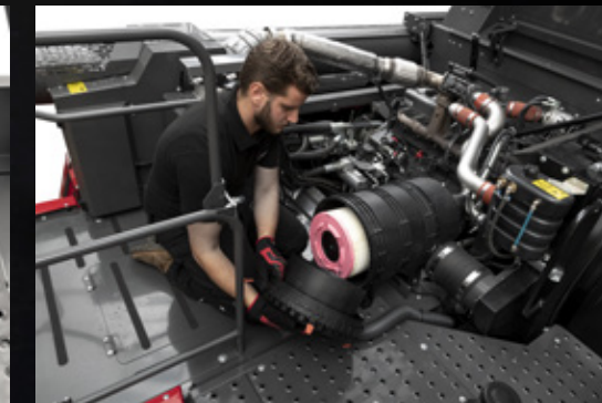
Ilmanpuhdistajan tarkastus ja puhdistus
