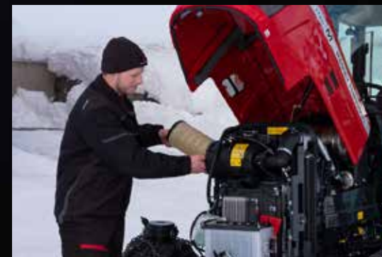
Kätevän kokoisen jäähdytyspaketin pääsee puhdistamaan ja huoltamaan helposti. Moottorin ilmansuodattimen vaihtaminen on erittäin helppoa.
