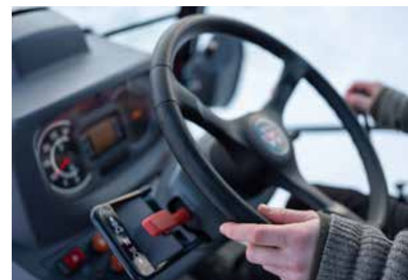
Mekaaninen voimansiirto Power Shuttle -laitteella MF 1700 M -mallissa 12Fx12R -nopeuksilla tarjoaa maksimaalisen mukavuuden kaikkiin sovelluksiin.
