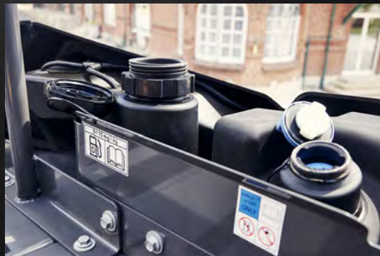
Helppo tankkaus – diesel- ja AdBlue-säiliöiden täyttöaukot ovat vierekkäin, joten niitä on kätevää käyttää
