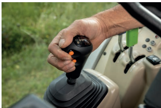
▲ Uusi vaihdevipu ja bowdenkaapeli sujuvoittavat käyttöä.
