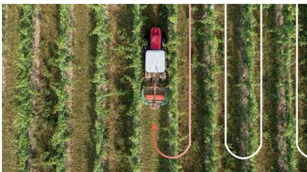
▲ SPEEDSTEER helpottaa ja nopeuttaa toimintaa päisteellä ja antaa käyttäjälle mahdollisuuden säätää ohjaussuhdetta.
