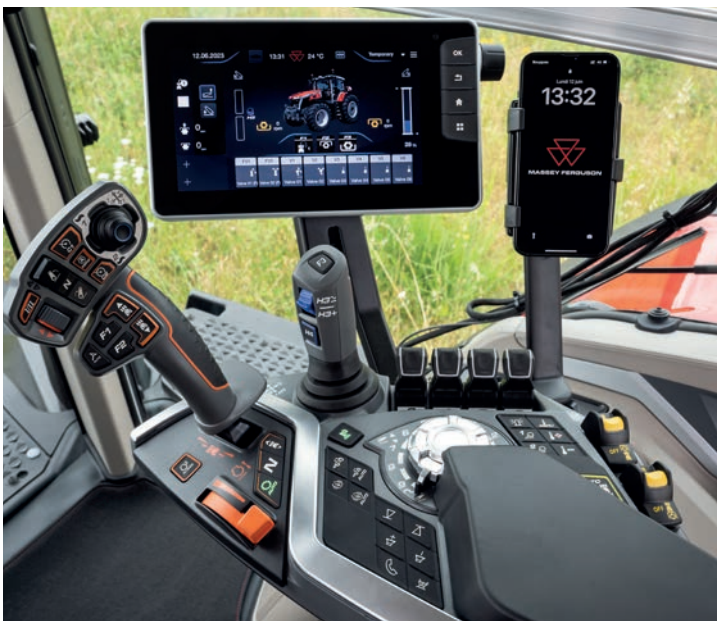
CONTROL CENTRE -KÄSINOJA Käsinojassa on uusi Multipad-vipu, joka mahdollistaa kattavan ohjauksen sormenpäällä.
