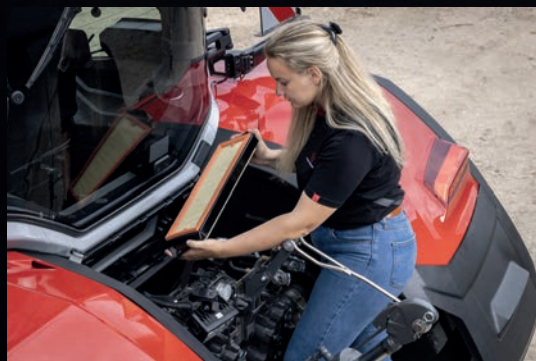
Ohjaamon ilmansuodatin on helposti irrotettavissa puhdistusta varten
