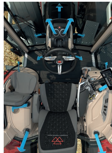
CONTROL CENTRE -KÄSINOJA Käsinojassa on uusi Multipad-vipu, joka mahdollistaa kattavan ohjauksen sormenpäällä.
