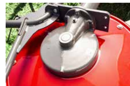
Pienet käyttökustannukset ja helppo huolto saavutetaan huoltovapailla laajakulmanivelillä ja hyvin saatavilla olevilla rasvanipoilla sekä öljytäytteisellä kulmavaihteella.
