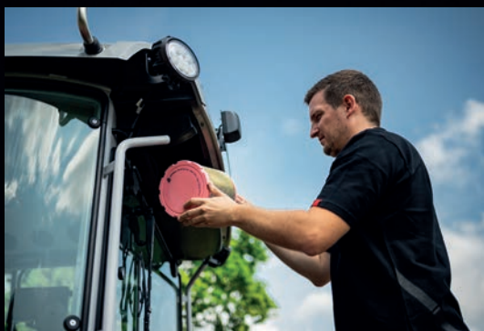
Ohjaamon ilmansuodatin on helposti irrotettavissa puhdistusta varten.
