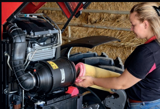
Moottorin ilmansuodattimen vaihtaminen on erittäin helppoa.
