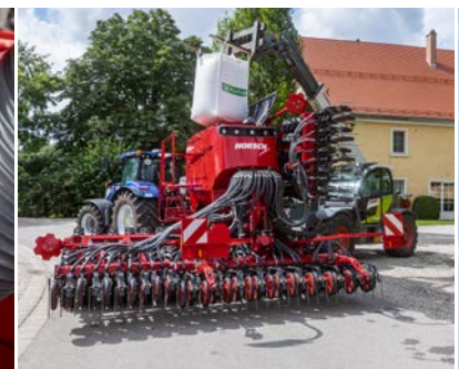
Pronto 6 DC -mallin toisen sivulohkon nosto mahdollistaa koneen täyden keskikokoisella kurottajalla
