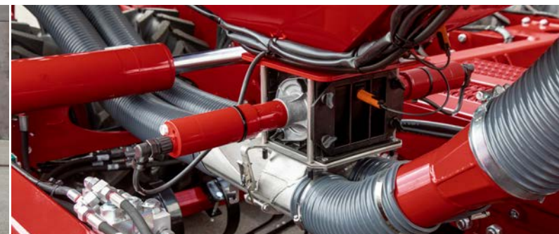
Kaksiosainen syöttölaite mahdollistaa VariableRate-toiminnon ja puolikkaan koneen sulun
