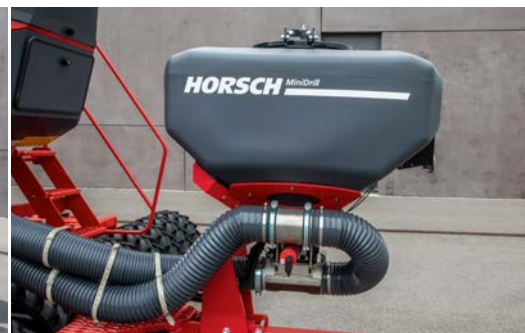
Lisävarusteen saatava MiniDrill G & F ja PPF -kylvölaite mahdollistaa 3. komponentin tarkan sijoituksen
