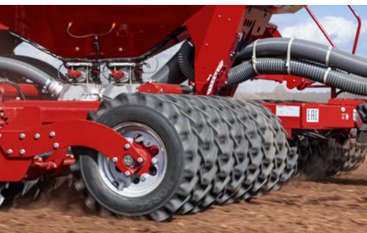
Lisävarusteena saatava etujrpyörästä siirtää painoa traktorin taka-akselilta, rikkoo kokkareita ja parantaa koneen maanpinnanseurainta.
