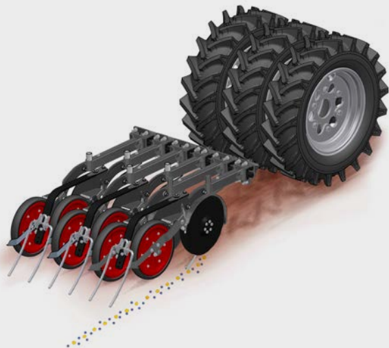
Kaksiosainen säiliö G & F 2 kylvökomponenttia syötetään erillisten syöttölaitteiden avulla samaan vakoön
