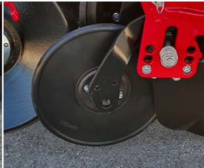
Kylvövaon jyräpyörä varmistaa siemenelle optimaalisen maakontaktin
