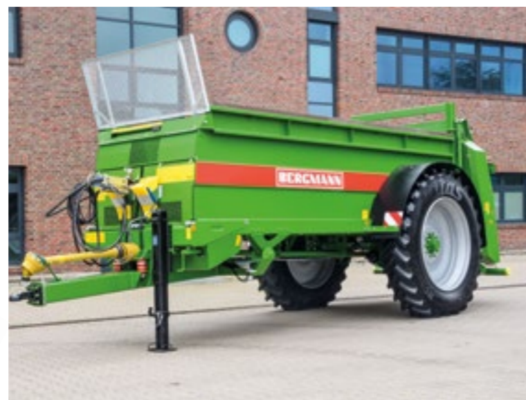
Matalarunkoinen tarkkuuslevitin TSW 2140 E jousitetulla alaisalla. "Jost" seisontatuki on vakiovaruste ja sen ansiosta koneen kytkentä on helppo. Sivulaitojen korkeutta - ja kuormatilan tilavuutta - voidaan lisätä korokelaitoja käyttämällä.
