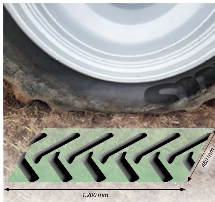
480/95 R 50 renkaiden kontaktipinta maahan on iso ja samalla käytettävä matala rengaspaine estää maan tiivistymisen.
