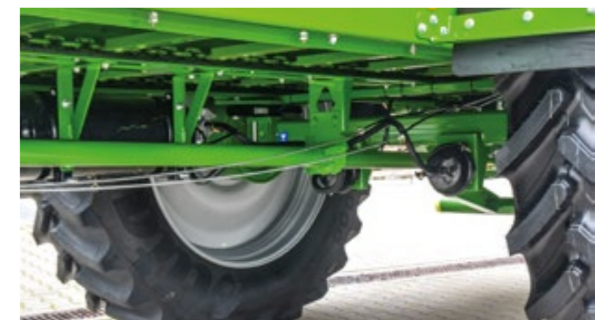
Runko , ilmajarrut vakiona ja hydrauliset jarrut lisävarusteena.
