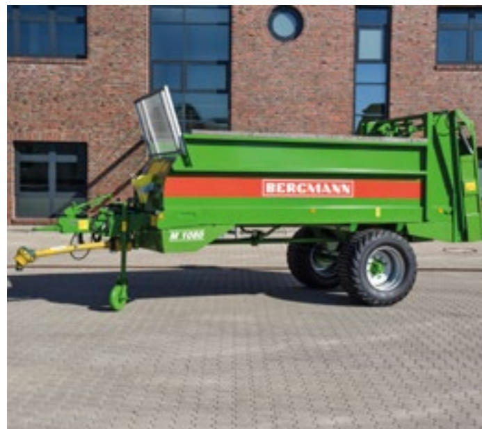
M 1080 – lannanlevittimessä on vahva runko, pultattu vetopuomi sekä vakaa ja vankka seisontatuki suurille kuormille. Lisävarusteena on saatavana yksisivuinen korokelaita kuormatilan suurentamiseksi.
