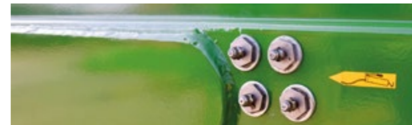
Kaikki voitelupisteet ovat helposti lähestyttävät tai ne on ryhmitetty voiteluryhmiksi nopeaa ja helppoa huoltoa varten.
