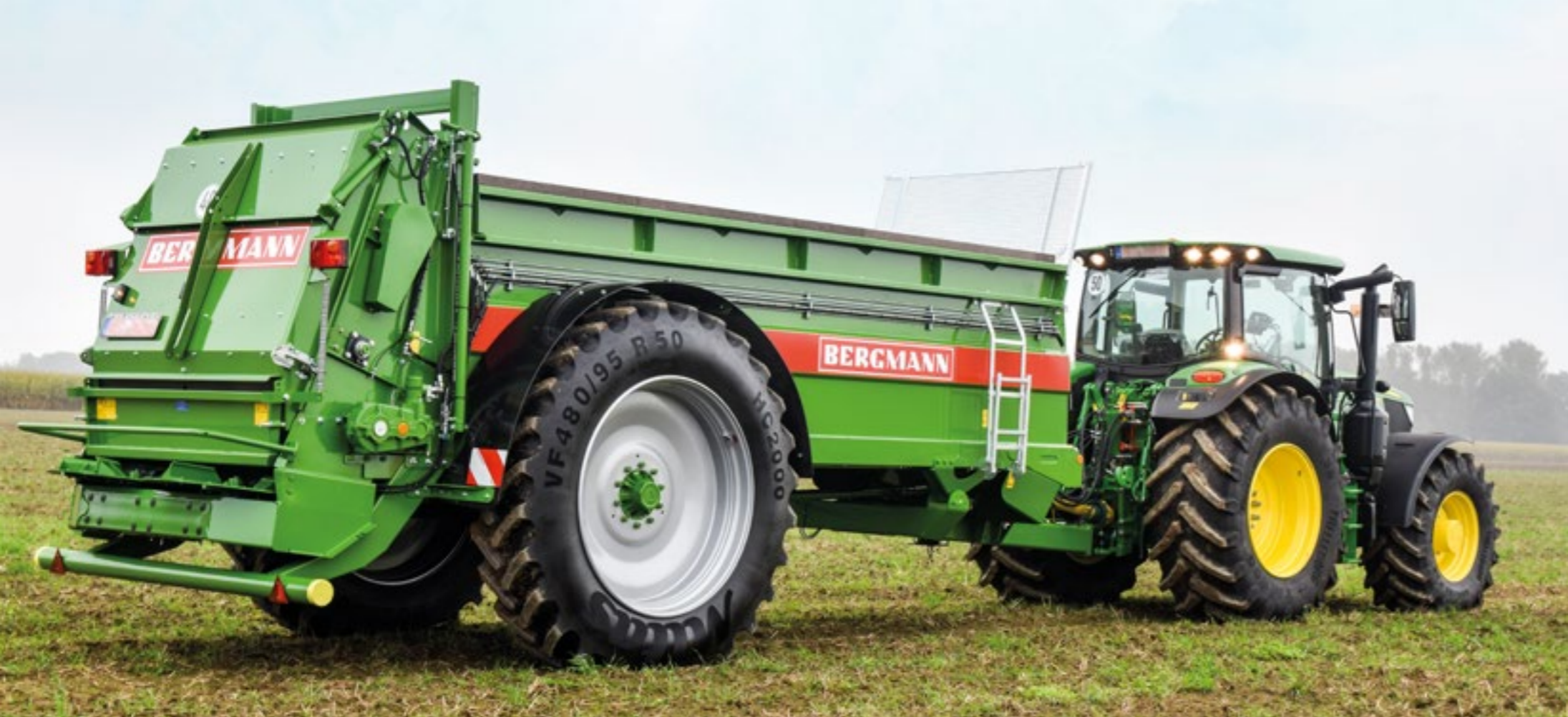
Tarkka hydraulisen annosteluseinän korkeuden näyttö . Suojasäleikkö antaa hyvän näkymän pohjakuljettimen ketjuille. Kuormatila ja pohjakuljetin ovat selvästi näkyvillä ikkunasta.
