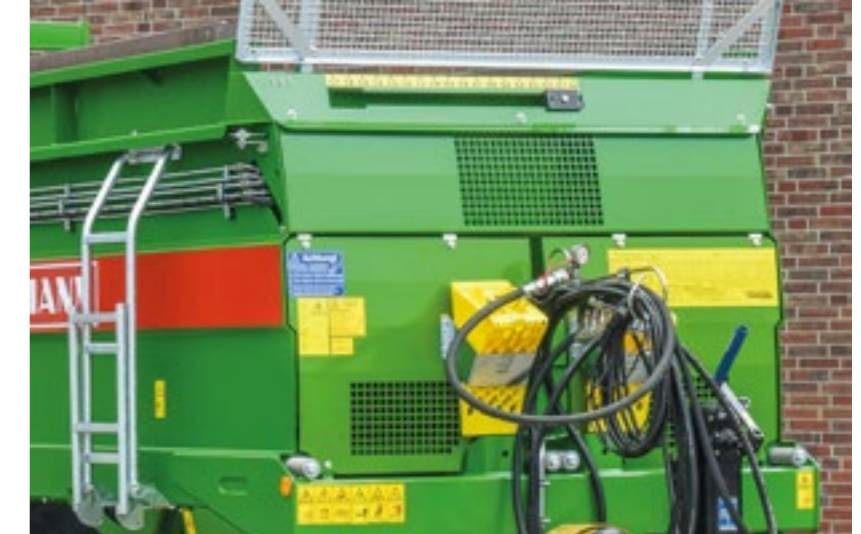
Tarkka hydraulisen annosteluseinän korkeuden näyttö . Suojasäleikkö antaa hyvän näkymän pohjakuljettimen ketjuille. Kuormatila ja pohjakuljetin ovat selvästi näkyvillä ikkunasta.
