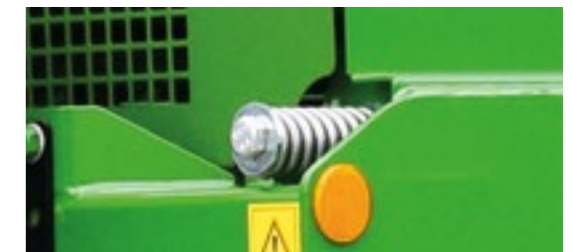
Automaattista kiristysjärjestelmää voidaan tarkkailla ohjaamosta ja neljää suuren lujuuden omaavaa pohjakuljettimen ketjua voidaan helposti säätää edestä. Näin voidaan varmistaa turvallinen joustava käyttö.
