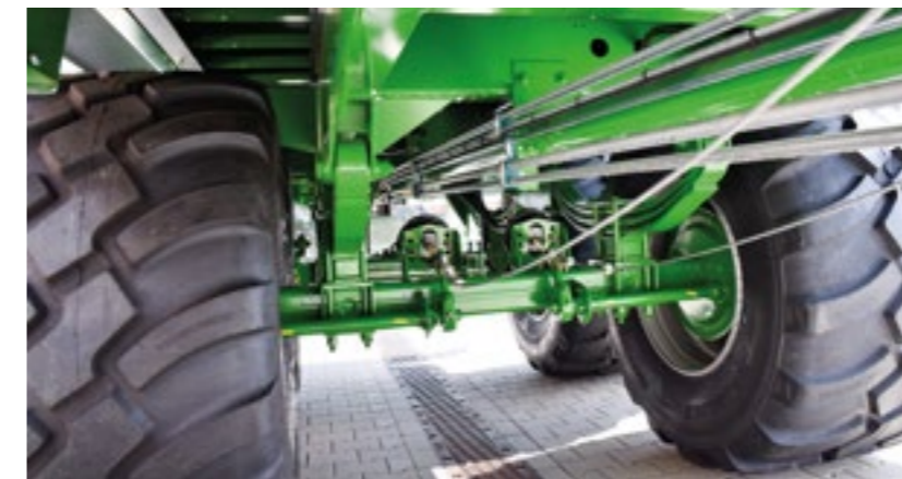
BERGMANN TSW 5210 W (W = punnitus) TSW 5210 W -koneessa on vakiona punnitusjärjestelmä tarkoilla korkean resoluution punnitustangoilla.
