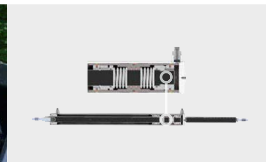
MotionControl vaimentaa puomin sivuttaissuuntaista liikettä
