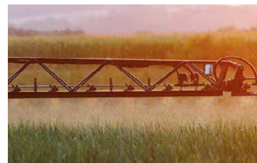
BoomControl – automaattinen korkeudensäätö ultraäänisensorien avulla
