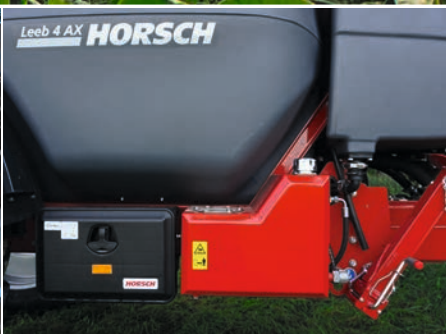
Oma hydraulijärjestelmä vähentää traktorille asetettavia vaatimuksia.
