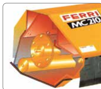
Controtelaio interno. Inner lining.
