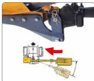
Ammortizzatore meccanico (salvaguardia bracci in caso di ostacoli). Mechanical breakaway (protection in the event of obstacles).
