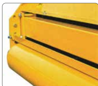
Rullo di appoggio regolabile in altezza. Height adjustable self-cleaning roller.
