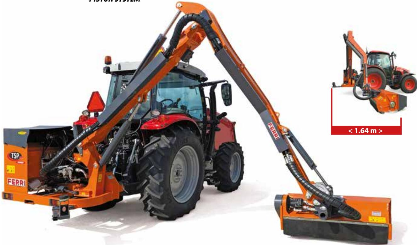
Le decespugliatrici idrauliche serie TSP Power sono caratterizzate da una avanzata tecnologia già nell'equipaggiamento di serie. Una elevata potenza grazie all'impianto idraulico a pistoni a circuito chiuso consente di erogare 74HP al rotore. Il comfort è assicurato dalla consolle "advance tronic" con comandi proporzionali. Doppio comfort offerto dalle versioni "Vision", oltre alla consolle, la posizione avanzata della testata trinciante consente la migliore visibilità operativa.
