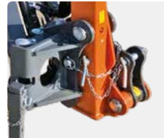
Dispositivo ammortizzatore meccanico, protezione completa in caso di urto contro ostacoli.
