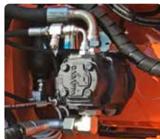
Impianto idraulico ad ingranaggi in circuito aperto.
