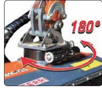
DUAL WAY: sistema di rotazione testata di 180° tramite ralla idraulica per utilizzo bidirezionale (optional).
