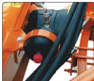
Sospensione oleopneumatica del corpo trinciante.
