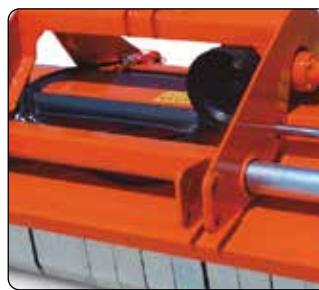
Attacco mobile con martinetto idraulico.
