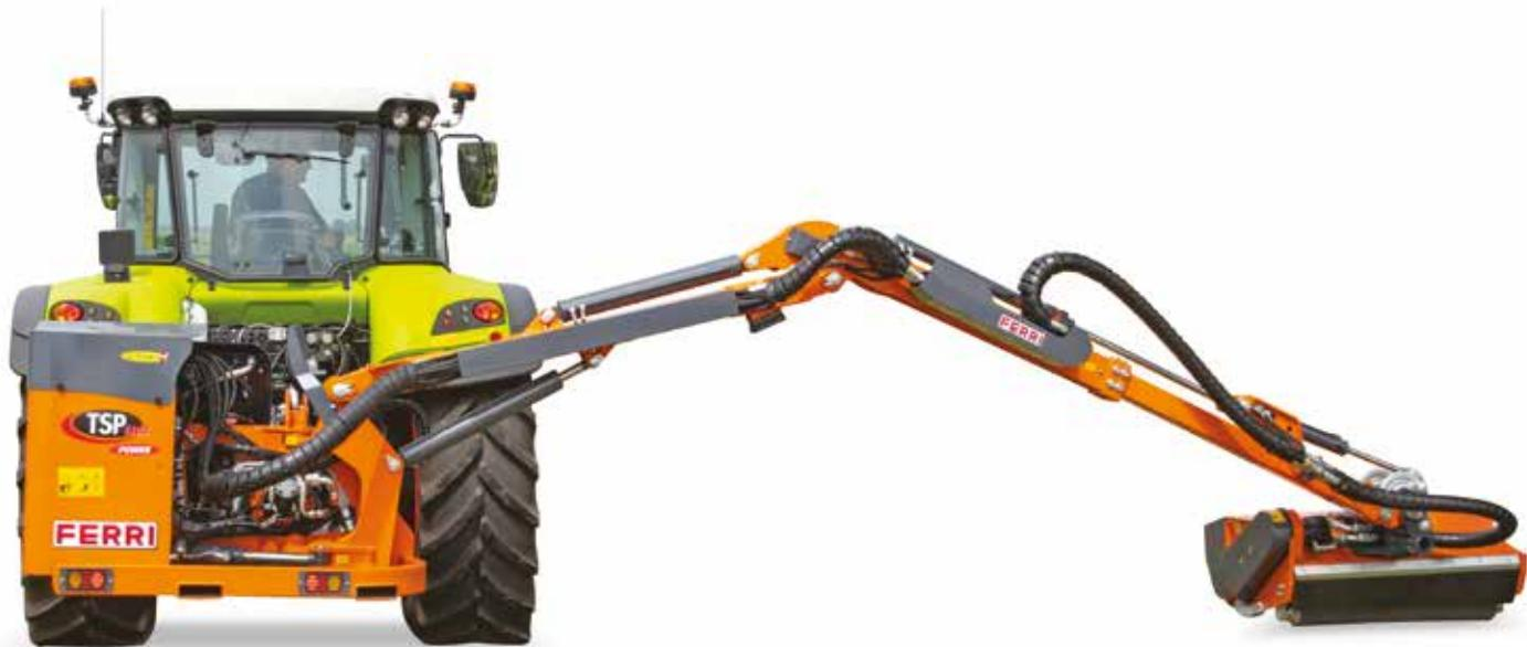
Le decespugliatrici idrauliche serie TSP Energy sono caratterizzate da una avanzata tecnologia già nell'equipaggiamento di serie. Una elevata potenza grazie all'impianto idraulico ad ingranaggi consente di erogare 54HP al rotore. Il comfort è assicurato dalla consolle "advance tronic" con comandi proporzionali. Doppio comfort offerto dalle versioni "Vision", oltre alla consolle, la posizione avanzata della testata trincante consente la migliore visibilità operativa.
