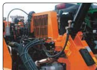
Scambiatore di calore con termostato.
