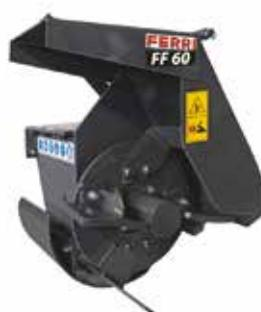
L'alimentazione del motore idraulico avviene mediante le prese d'olio della decespugliatrice. Al momento dell'ordine è indispensabile specificare le caratteristiche ed il modello della decespugliatrice alla quale verrà montato l'attrezzo terminale.
