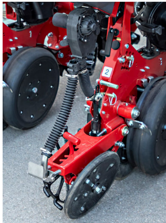
Mikrorakeiden rivikohtainen levitysyksikkö kahdella levityspisteellä
