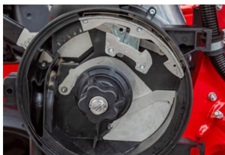
Universaalia yksittäissyötintä ei tarvitse säätää.
