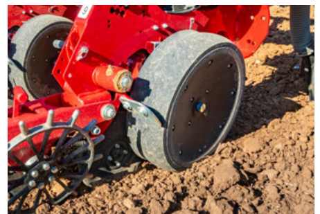
Vakiosyvyysäätpyörä normaalille maaperälle.
