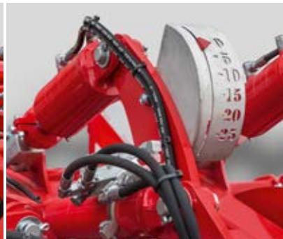
Valinnainen Joker 5/6/8 RT hydraulinen syvyydensäätö
