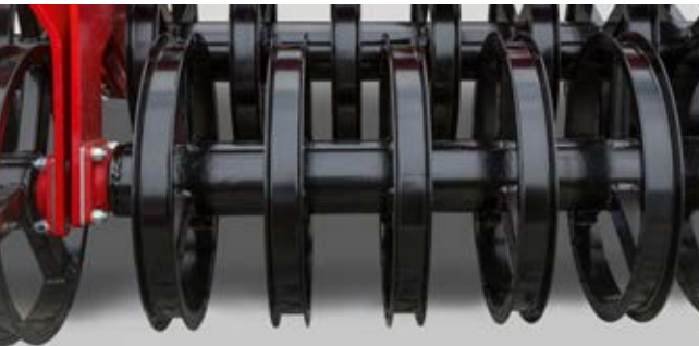
Kaksoistiivistysjyrä RollPack rikkoo kokkareita ja tiivistää pellon pinnan
