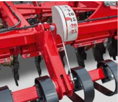
Crossbar Hydraulinen syvyyden säätö parhaaseen tulokseen
