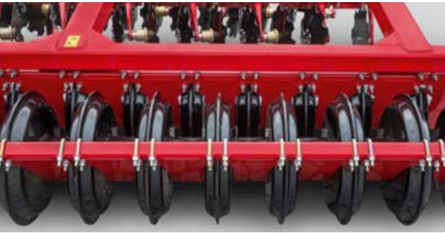
Kaksoisteräskiekkojyrä optimoi tiivistyksen jäykimmilläkin mailla
