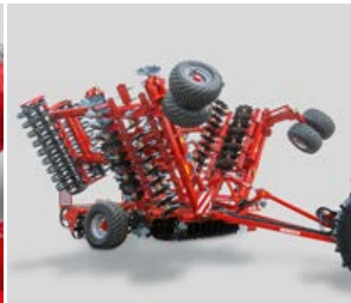
Joker 10/12 RT Kompakti kuljetusleveys; 3 m leveys ja 4 m korkeus
