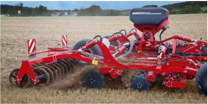
Joker RT lisävarusteena MiniDrill: Sementen jakautuminen pakkerin edessä ohjainlevyn avulla
