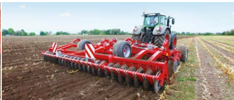
Tehokkaat pakkerit varmistavat kokkareiden hienontamisen ja maan tiivistymisen
