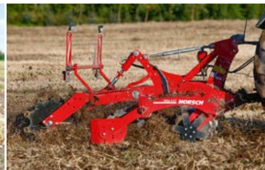
Vahva DiscSystem varmistaa maan optimaalisen sekoituksen ja tasoituksen
