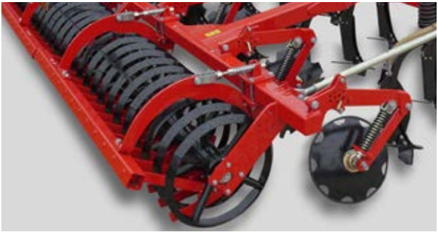
RollCut pakkeri hyvä pintarakenne keskiraskailla ja kivettömällä peloilla
