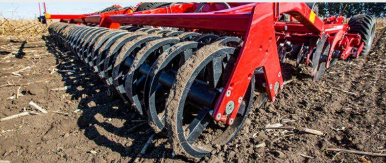
Kaksoistiivistysjyrä RollPack rikkoo kokkareita ja tiivistää pellon pinnan
