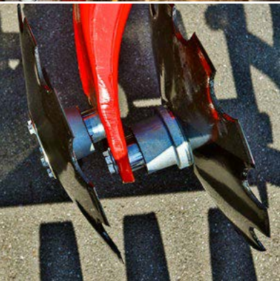
Kiekkojen asennus pareittain estää tukkeutumisen
