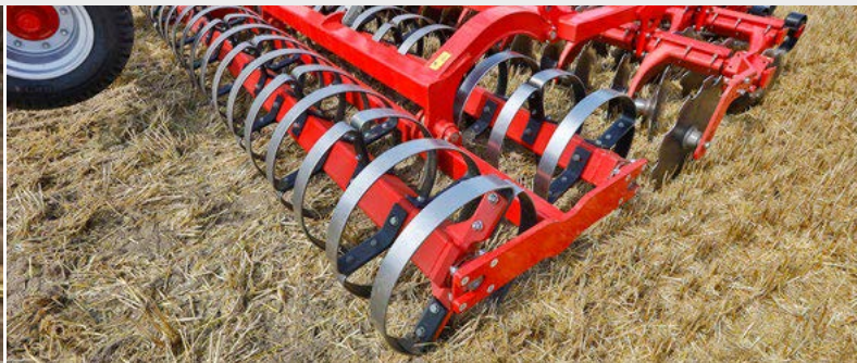
Double RingFlex pakkeri – pieni tehovaatimus ja suuri kantokyky
