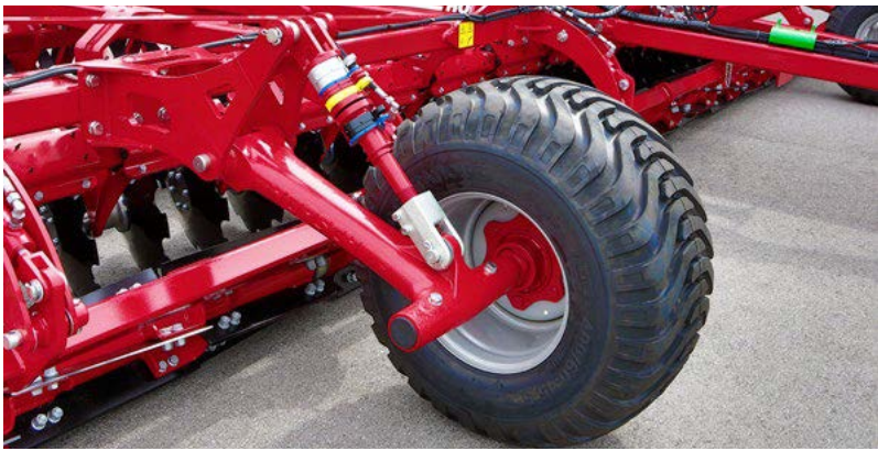
Työsyvyydensäätö klipsein (vakio)
