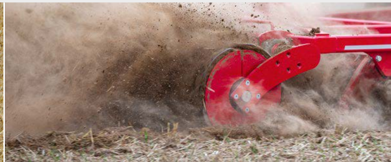
RollFlex pakkeri – murustaa hyvin maata värisevien elementtien avulla
