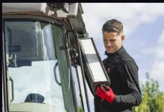
Ohjaamon ilmansuodatin on helposti irrotettavissa puhdistusta varten.
