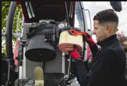
Moottorin ilmansuodattimen vaihtaminen on erittäin helppoa.
