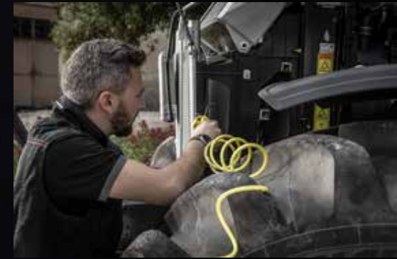
Jäähdytyspaketti on helposti käytettävissä, mikä helpottaa ja nopeuttaa sen puhdistamista.
