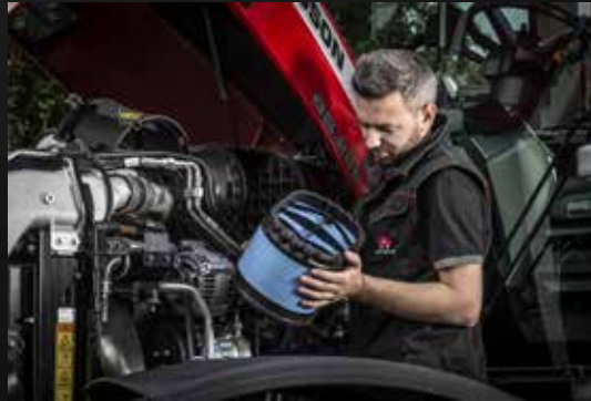
Moottorin ilmansuodattimen vaihtaminen on erittäin helppoa.
