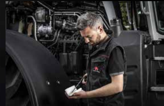
Etuakseli ja kapea konepelti helpottavat öljyn määrän tarkistamista ja suodattimen vaihtamista.
