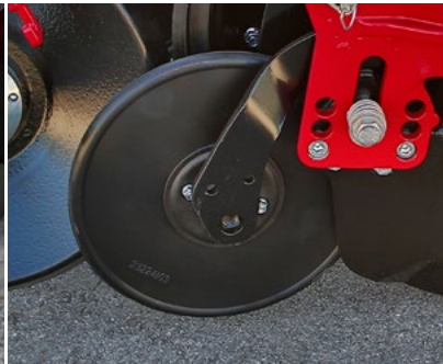
Kylvövaon jyräpyörä varmistaa siemenelle optimaalisen maakontaktin
