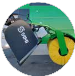
Kauhaharjan tyhjennystä varten kauha on kallistettava eteenpäin ja harjan runko on nostettava hydraulisesti.
