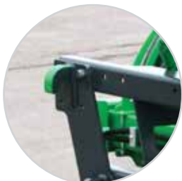
SAMIn kaikkien peruskonevetoisten työlaitteiden kiinnityskoukut on maalattu kontrastimaalilla helpottamaan työlaitteen kiinnittämistä.
