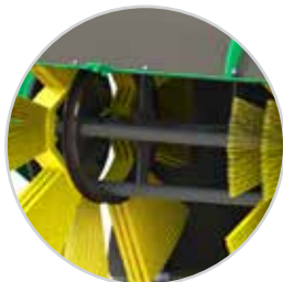
Erikoisrakenteinen harjatelä estää lian kerääntymisen telan keskelle ja helpottaa kuluneiden lamellien vaihtamista.
