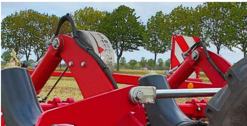
Kultivaattorin hydraulinen syvyydensäätö
