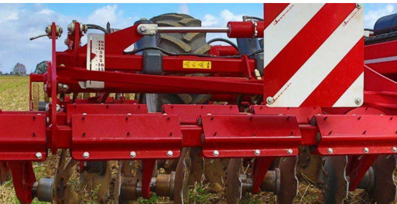
Lautasmuokkaimen hydraulinen työsyvyydensäätö
