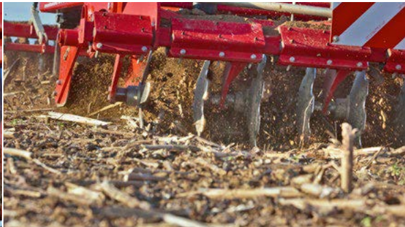
DiscSystem huolehtii tehokkaasti matalasta muokkauksesta
