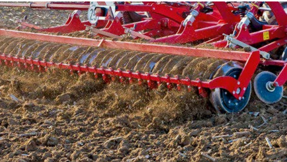
SteelDisc pakkeri on ihanteellinen raskaidenkin maiden tiivistämiseen
