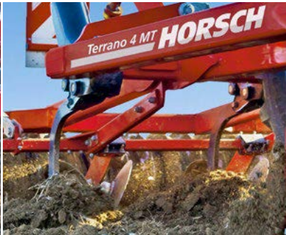
LD vantailla varustetut TerraGrip piikit irrottavat maata syvältä
