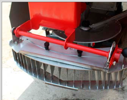
Levitysrajoitin varmistaa tarkan reunalevityksen
