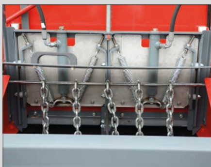
Hydraulinen sulkua mahdollistaa puolen koneen levityksen kiilamaisilla lohkoilla
