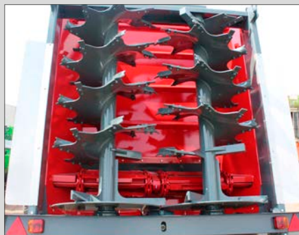
2 m leveä levityskoneisto tarkkaan levitykseen
