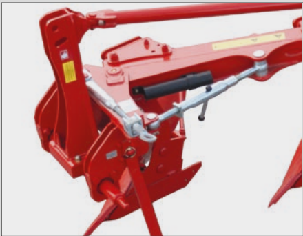
Vanttiruuvisäätö auran säätöön ensimmäisen viulun leveyden säätö ja auran vetokulman säätö
