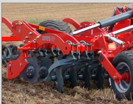
Isot muotoillut lautaset varmistavat tehokkaan muokkauksen ja isonkin kasvujättemäärän sekoittumisen maa-aineksen kanssa
