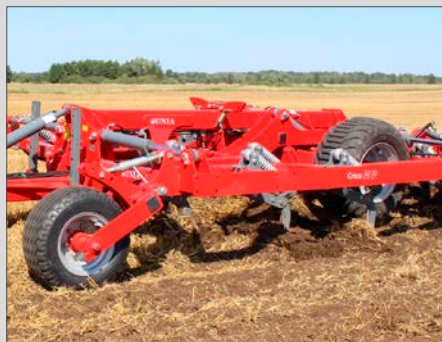
Avara runkorakenne ja CX-piikit varmistavat tukkeutumattoman muokkauksen
