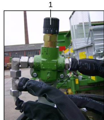
Kuva: Säätölaitteen nuppi
