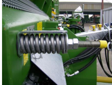
Kuva: Pohjakuljettimen ketjun säätö (ulkopuolella)
