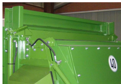
Kuva: Annosteluseinän korotus
