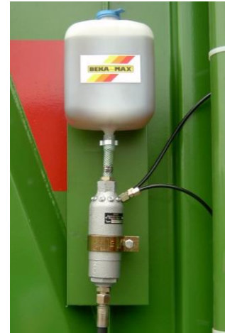
Kuva: Murskainyksikön käyttöketjun automaattinen voitelujärjestelmä
