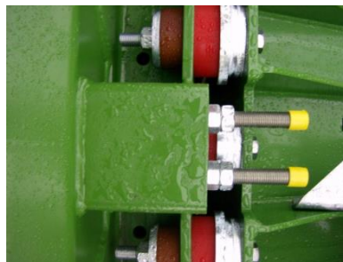
Kuva: Pohjakuljettimen ketjun säätö (keskellä)
