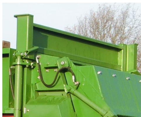
Kuva: Annosteluseinän korotus
