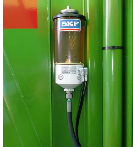
Kuva: Murskainyksikön käyttöketjun automaattinen voitelujärjestelmä
