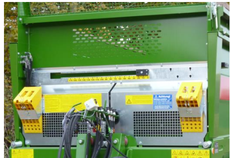
Kuva: Annosteluseinän korkeusnäyttö
