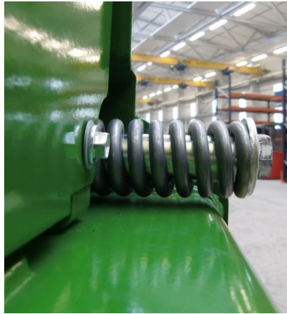
Kuva: Pohjakuljettimen ketjun säätö (ulkoreuna)
