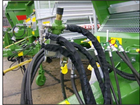
Kuva: Virtauksen säätöventtiili
