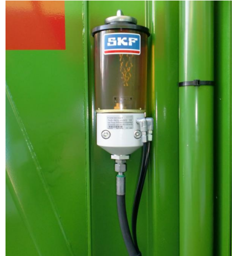
Kuva: Murskainyksikön käyttöketjun automaattinen voitelujärjestelmä
