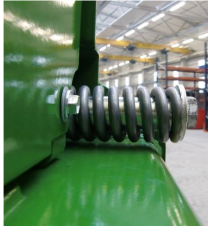
Kuva: Pohjakuljettimen ketjun säätö (ulkoreuna)
