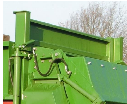
Kuva: Annosteluseinän korotus
