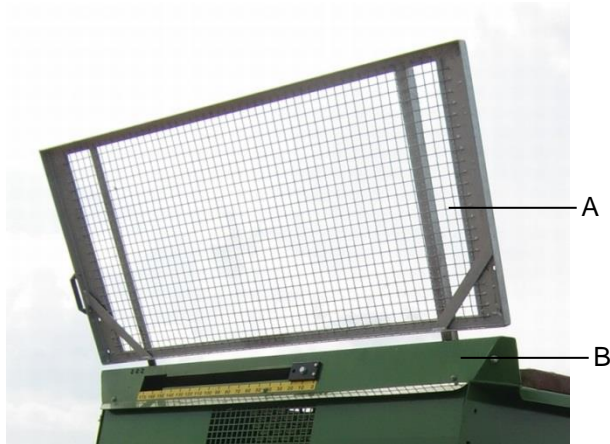
Kuva: Suojasäleikkö etuseinässä
