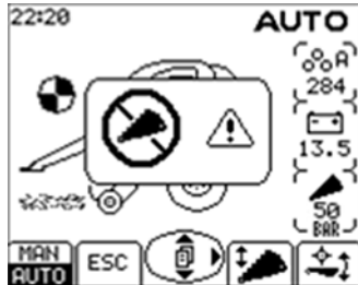
Terät liian alhaalla -varoitus
