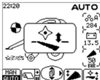
Pohja ei ole työskentelyasennossa -varoitusta
