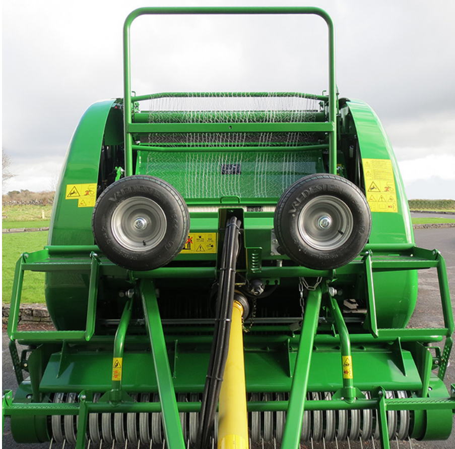
Noukkimen pyörät kuljetusasennossa
