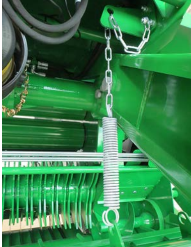
Tasauslevyn säätöketju ja -levy
