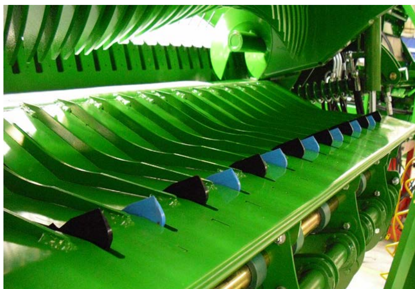
Tukoksenpoistotila, terät vetäytyneinä ja kuilun pohja laskettuna
