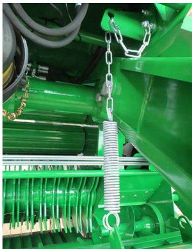
Tasauslevyn säätöketju ja -levy
