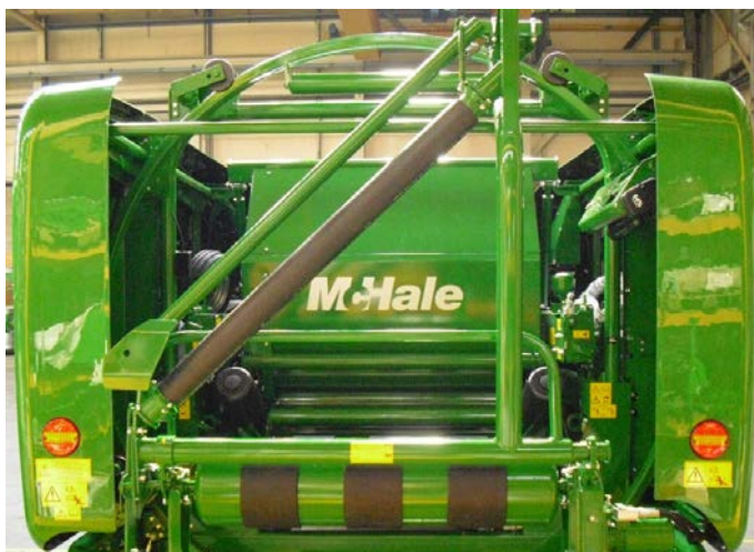
Maantiekuljetusasento (paalin kääntölaite)
