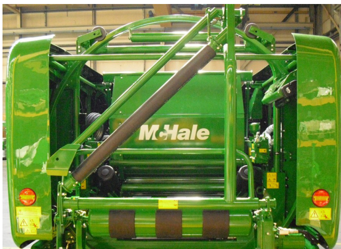
Maantiekuljetusasento (paalin kääntölaite)
