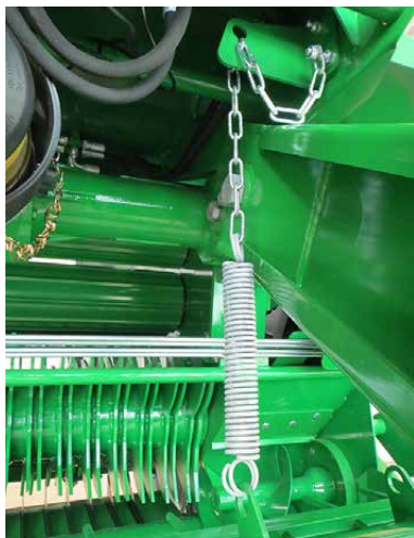
Tasauslevyn säätöketju ja -levy
