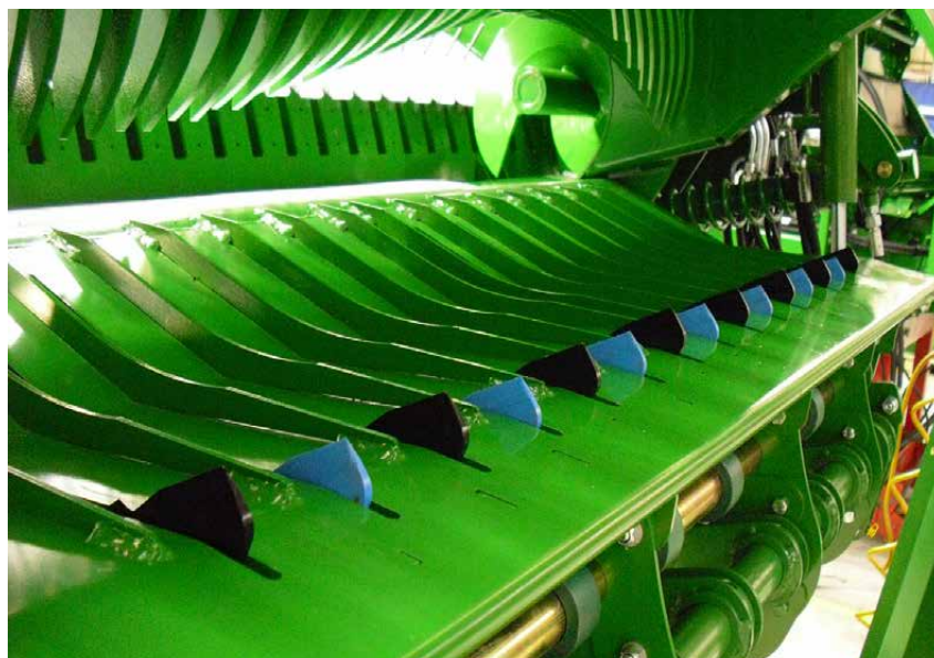
Tukoksenpoistotila, terät vetäytyneinä ja kuilun pohja laskettuna
