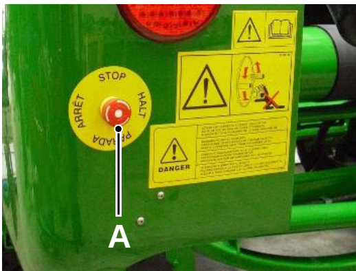
Pysäytyskytkin A sijaitsee vasemman takapaneelin vasemmassa takanurkassa
