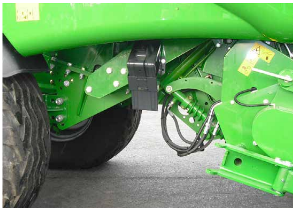
Pyöräkiilat (yksi koneen kummallakin puolella)
