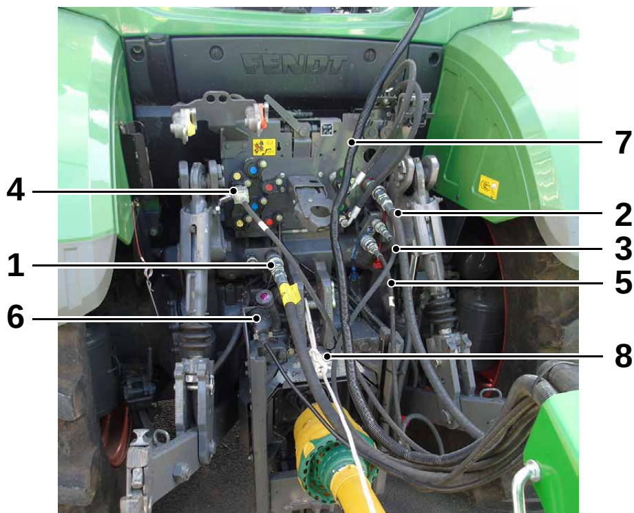
Hydrauliletkujen ja sähköjohdinten mahdollinen asetelma
