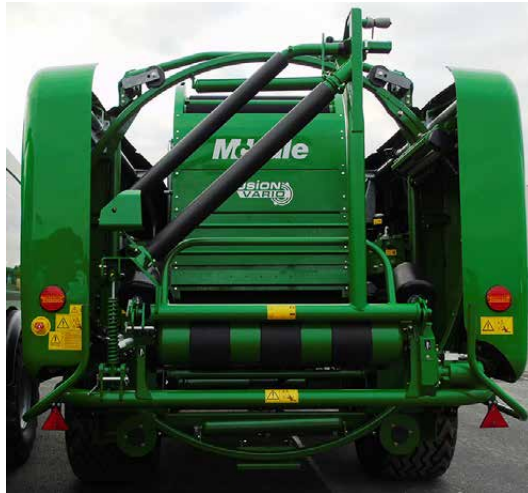
Maantiekuljetusasento (paalin kääntölaite)
