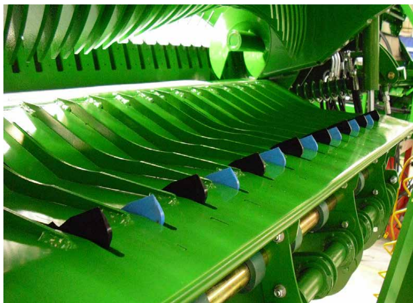
Tukoksenpoistotila, terät vetäytyneinä ja kuilun pohja laskettuna
